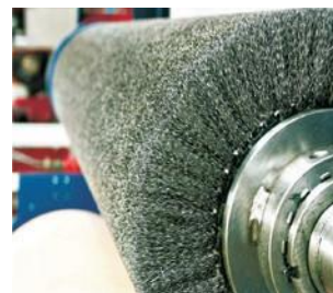
Притупление кромок (2 щетки из нержавеющей стали)
