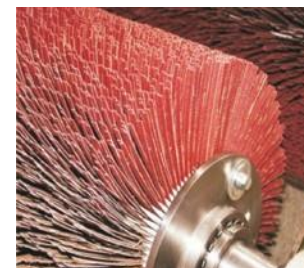
Скругление (2 щетки с абразивной лентой)
