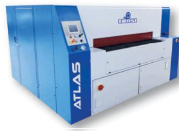
ATLAS EBB (удаление грата + удаление окиси + притупление кромок)
