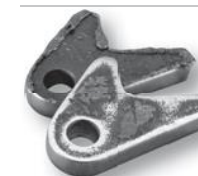
Удаление грата (после кислородной резки)
