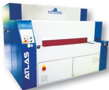
ATLAS EQ (удаление грата + обработка с 2-х сторон)
